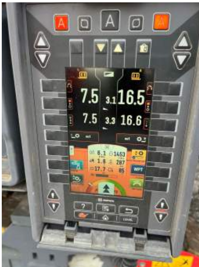
Slika 20: Nastavitev globine frezanja Vir: lasten
