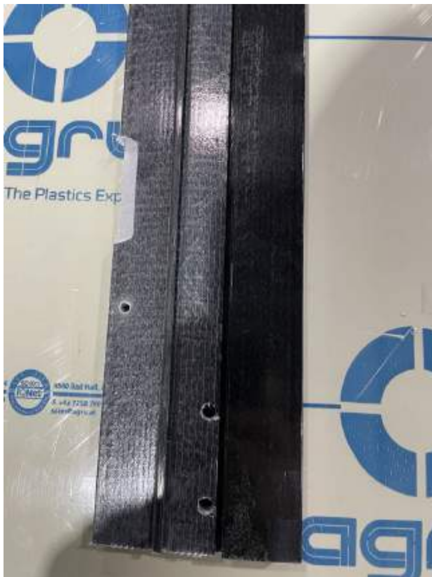
Slika 34: Izvrtane luknje za montažo in stranski izrez za drenažo
