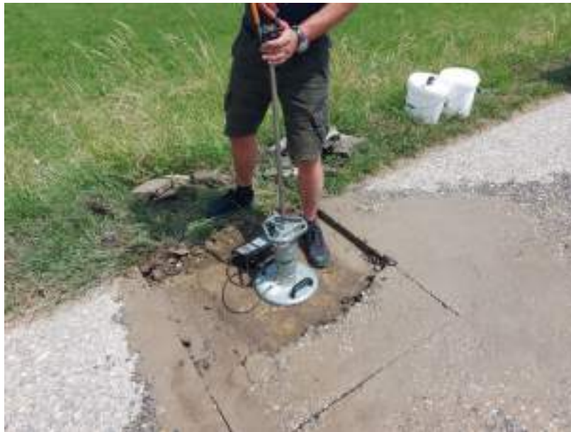
Slika 12: Meritev nosilnosti nevezane nosilne plasti z dinamično ploščo
