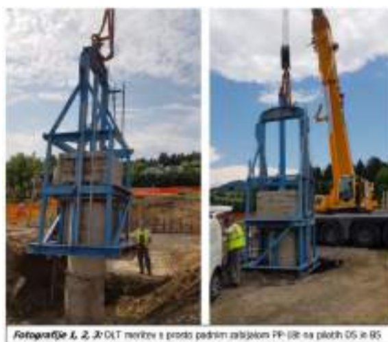
Slika 12: Dinamični obremenilni test (nakupovalni center CP Ravne)
