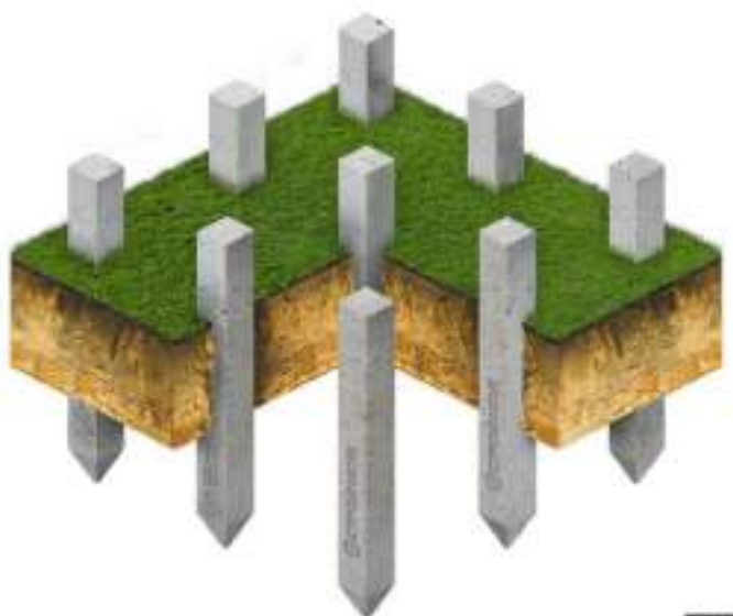
Slika 31: Armiranobetonski zabiti piloti
