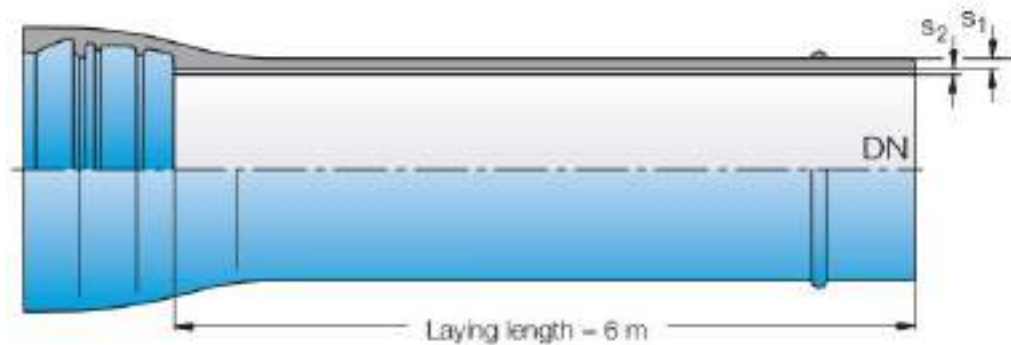
Slika 19: Prerez cevi iz nodularne litine
