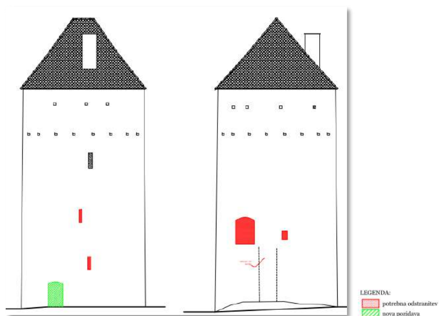
Slika 14: Posegi na severni in vzhodni fasadi
