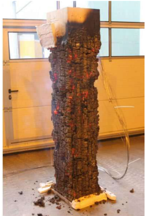
Slika 12: Požarni preizkus lepljenega lesa
