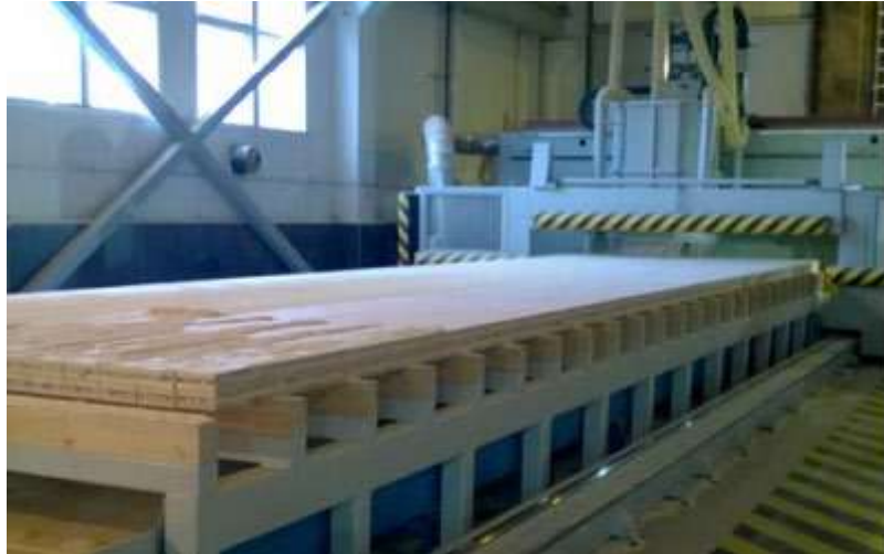
Slika 4: CLT plošča na končni obdelavi
