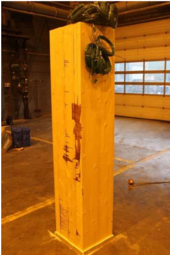
Slika 12: Požarni preizkus lepljenega lesa
