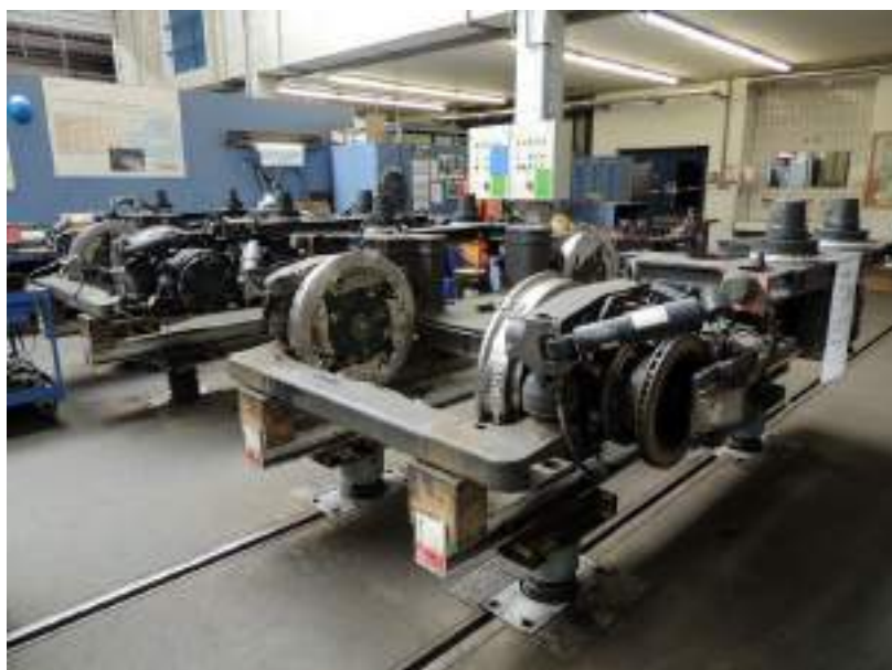
SLIKA 1: CELOTNO PODVOZJE PORTALNE OSI S KOLESI
