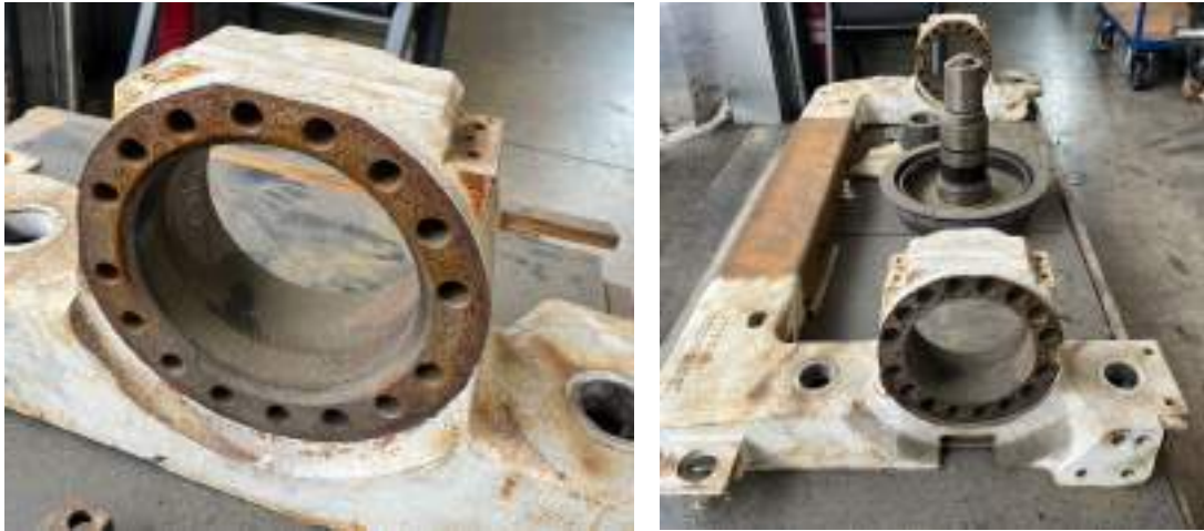
Slika 2: OBRABLJENO MESTO NA OBDELOVANCU
