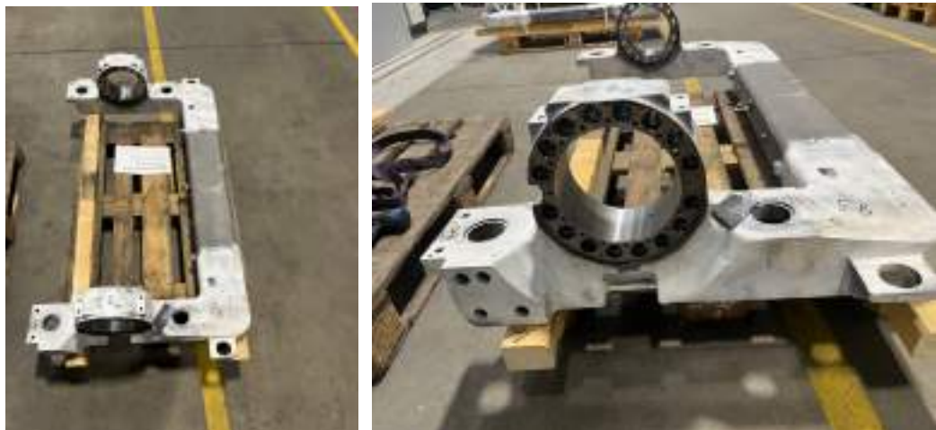
SLIKA 3: PORTALNA OS, PRIPRAVLJENA NA METALIZACIJO (IZVRTINA, POVEČANA NA Ø 180,5 MM)
