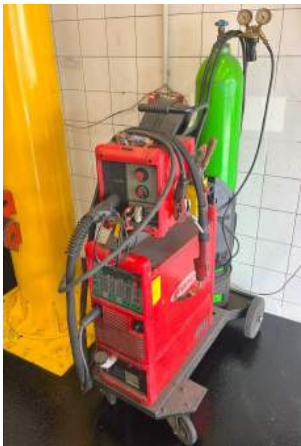
SLIKA 26: APARAT ZA VARJENJE
