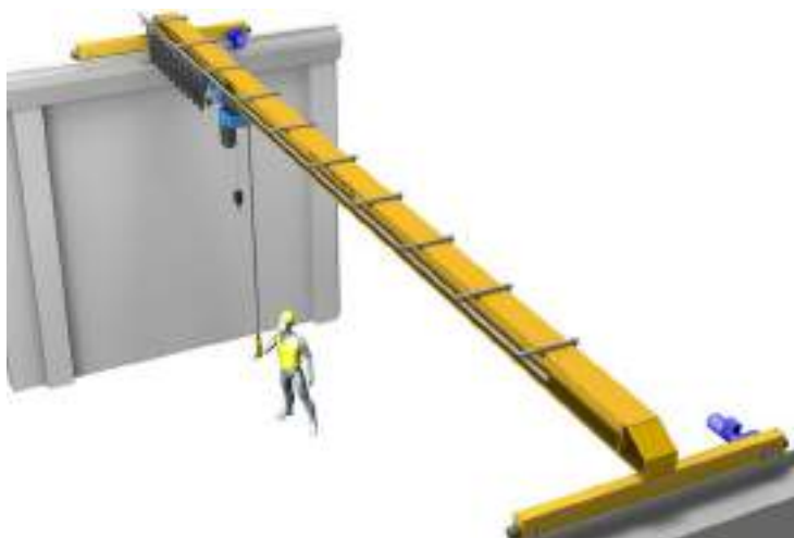
SLIKA 38: PRIMER MOSTNEGA DVIGALA
