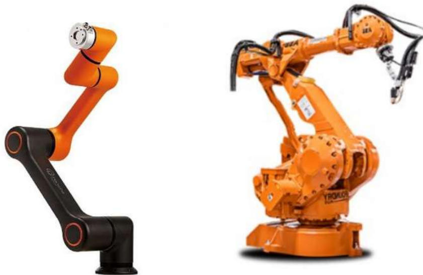
Slika 8: Kolaborativni robot (levo) in klasični industrijski robot (desno)
