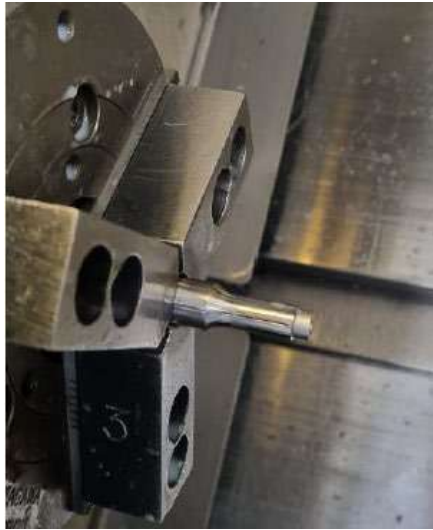
Slika 12: Tretje vpetje – prevpenjanje in izdelava špice Vir: (BTS Company d. o. o., 2023)
