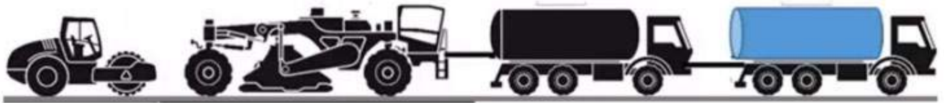
Slika 16: Vrstni red gradbene mehanizacije med postopkom.
