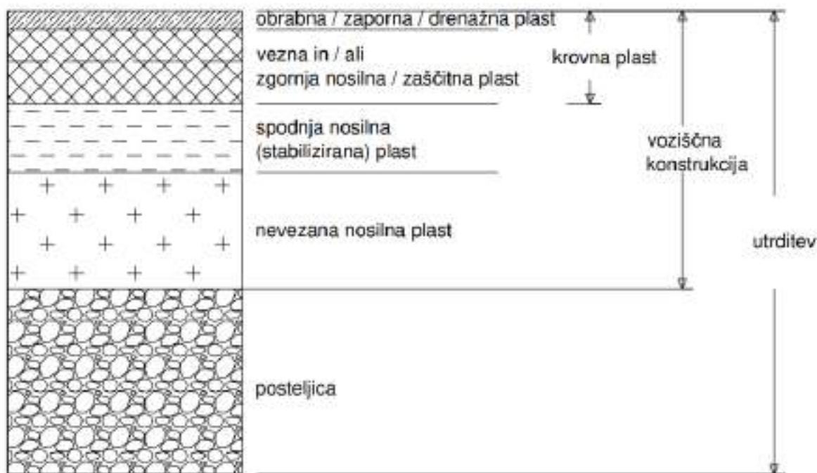
Slika 10: Prečni prerez voziščne konstrukcije.
