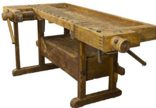
Slika 5: Stara delovna miza z integriranimi primeži
