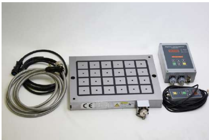
Slika 11: Elektropermanentna magnetna miza
