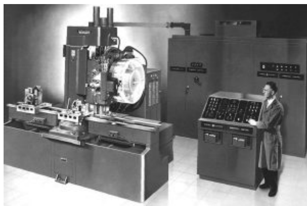
Slika 6: Prvi CNC-stroj iz leta 1952
