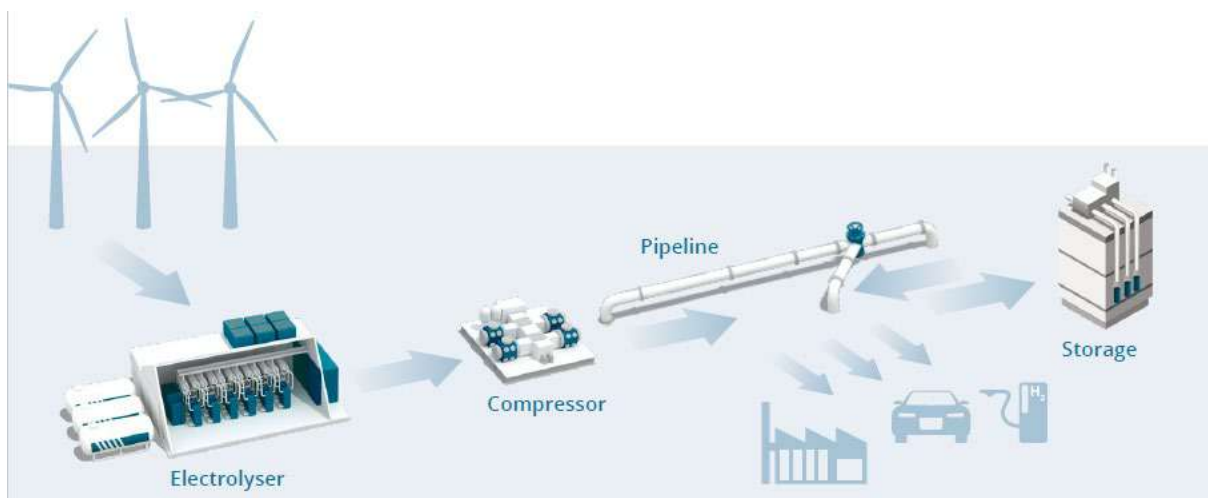
Slika 9: Elektroliza – kompresija – prenos/shranjevanje
