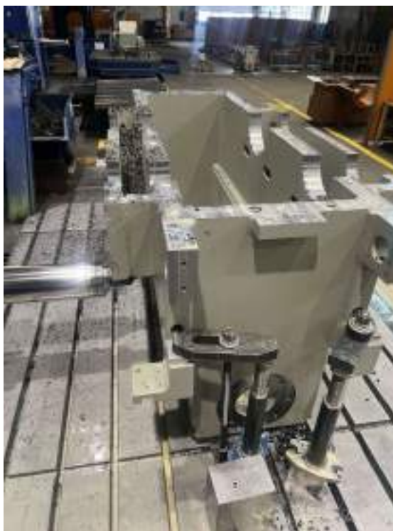
Slika 56: Obdelava spodnjega ohišja reduktorja Vir: Viri podjetja Mega Metal
