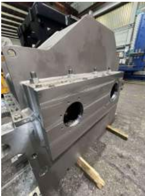
Slika 65: Pravilno odlaganje kosa na les zaradi preprečevanja poškodbe obdelanih površin
