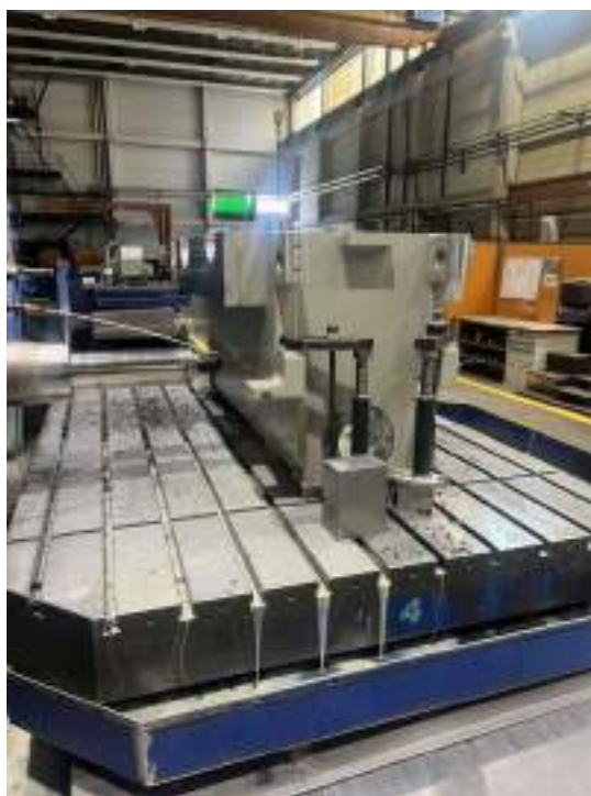
Slika 57: Vrtanje lukenj za navoje M24 Vir: Viri podjetja Mega Metal
