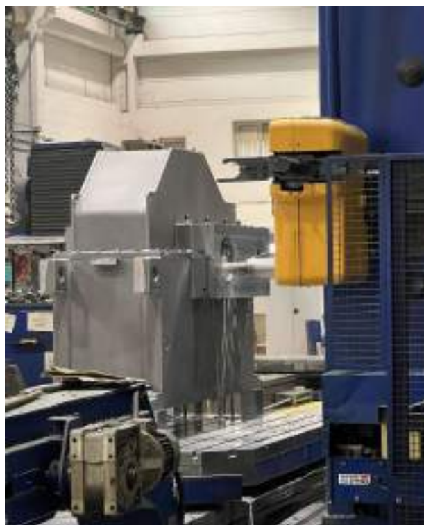
Slika 64: Uporaba orodja za obdelavo oljnih kanalov za ležaje
