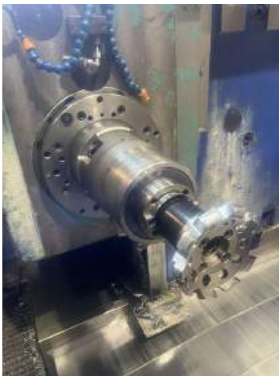
Slika 67: Groba frezna glava D160 x 45°
