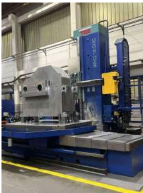
Slika 63: Fina oziroma končna obdelava reduktorja (luknje za mazanje in oljni kanali)
