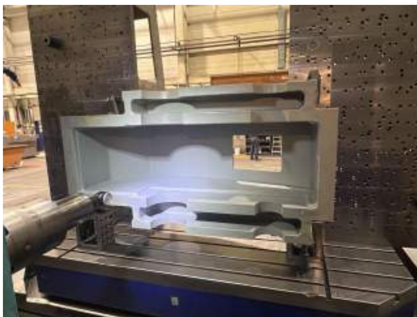
Slika 41: Postavljanje zgornjega ohišja in vpenjanje
