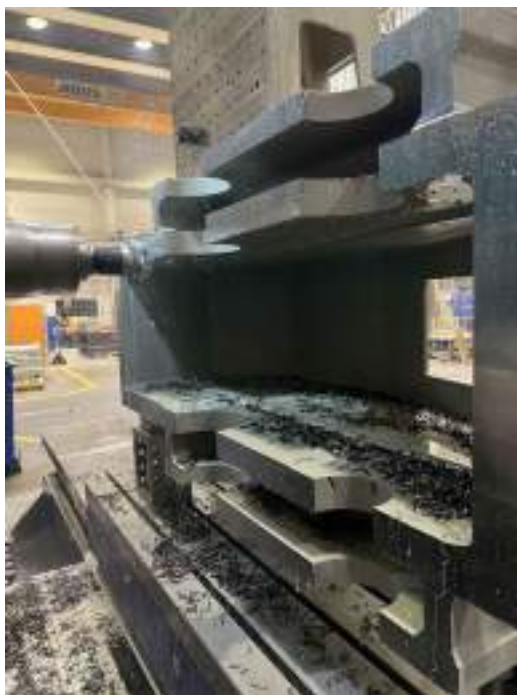
Slika 54: Rezkanje – zgornje ohišje reduktorja
