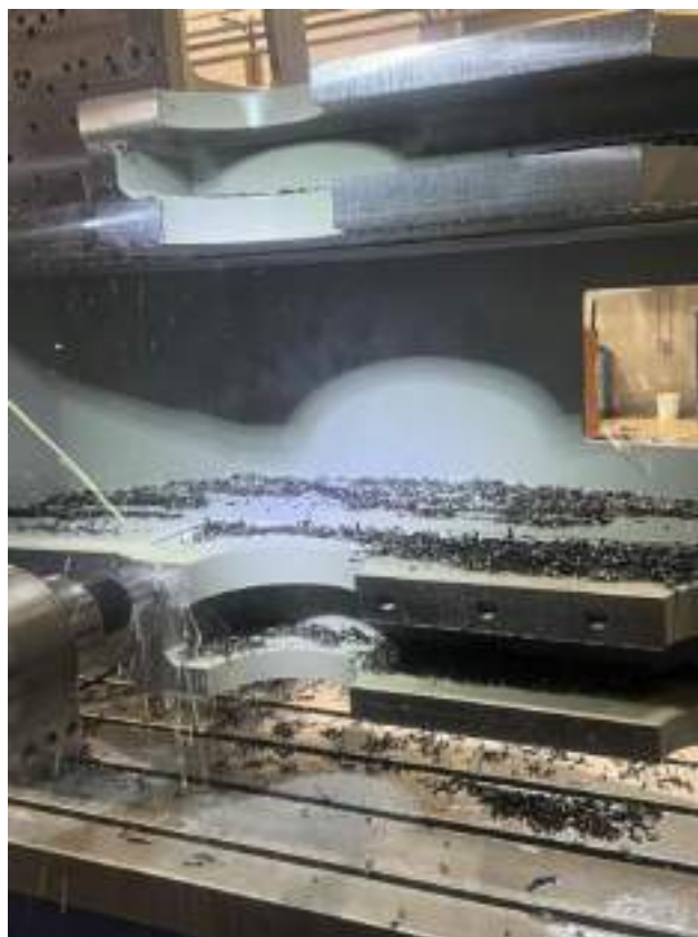
Slika 71: Predvrtanje vodilnih lukenj s topovskim svedrom
