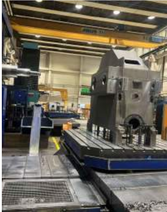
Slika 52: Pravilno vpenjanje in postavljanje vpenjala
