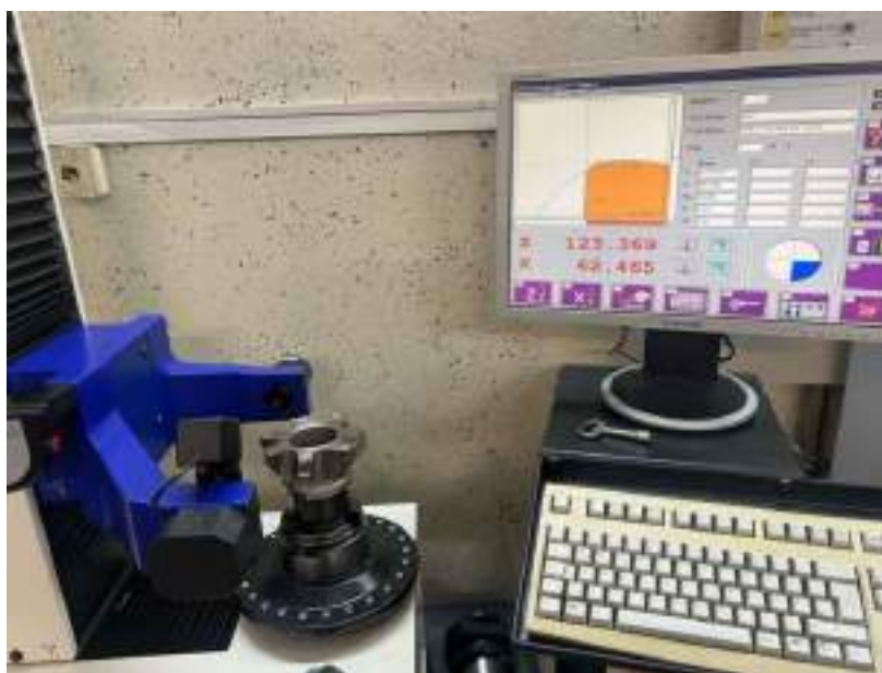
Slika 50: Merilno orodje (ZOLLER) za umerjanje in podajanje dimenzij orodja
