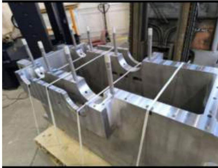
Slika 60: Postavljanje palic za montažo zgornjega in spodnjega ohišja
