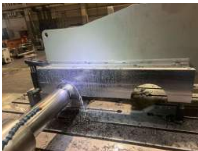
Slika 55: Obdelava zgornjega ohišja in ohišja za ležaj 35 KB 03
