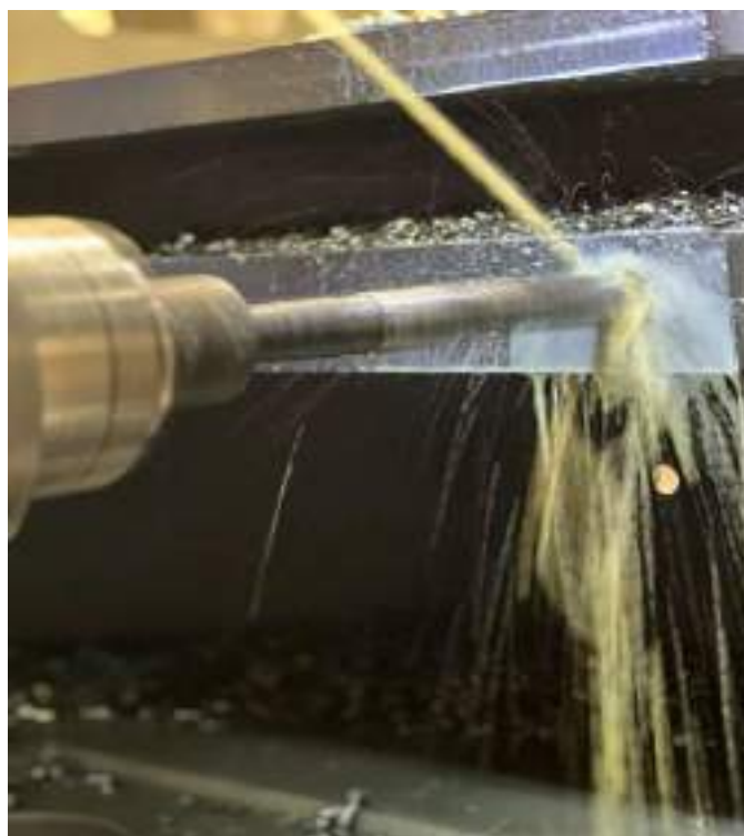
Slika 72: Globinsko vrtanje lukenj za montažo spodnjega in zgornjega ohišja D37 mm x 600 mm
