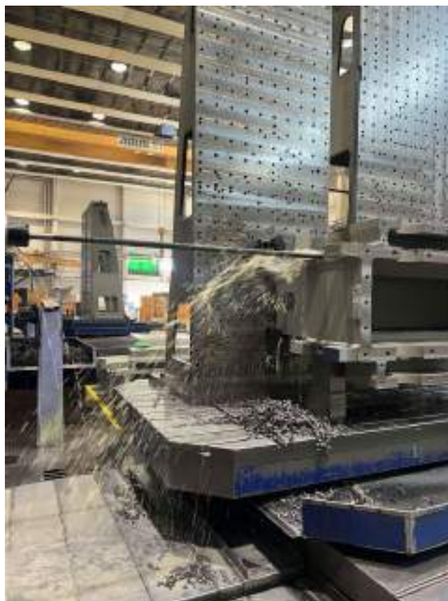
Slika 59: Vrtanje lukenj za filtracijo in čiščenje olja med obratovanjem reduktorja D35 mm
