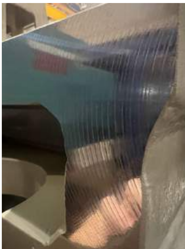
Slika 68: Nastanek neustrezne obdelave
