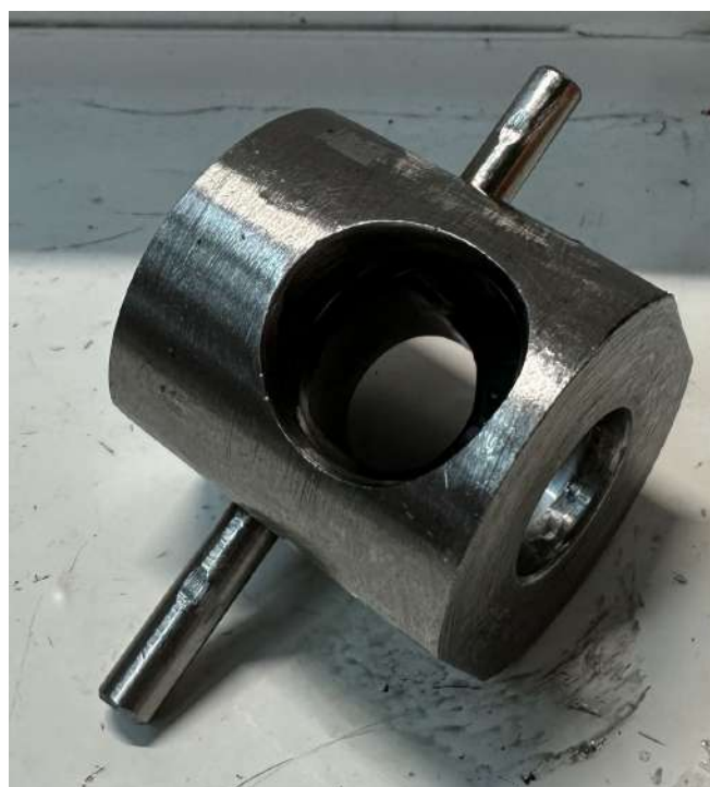
Slika 13: PokaYoke za preverjanje ustrezne velikosti kroglic.
