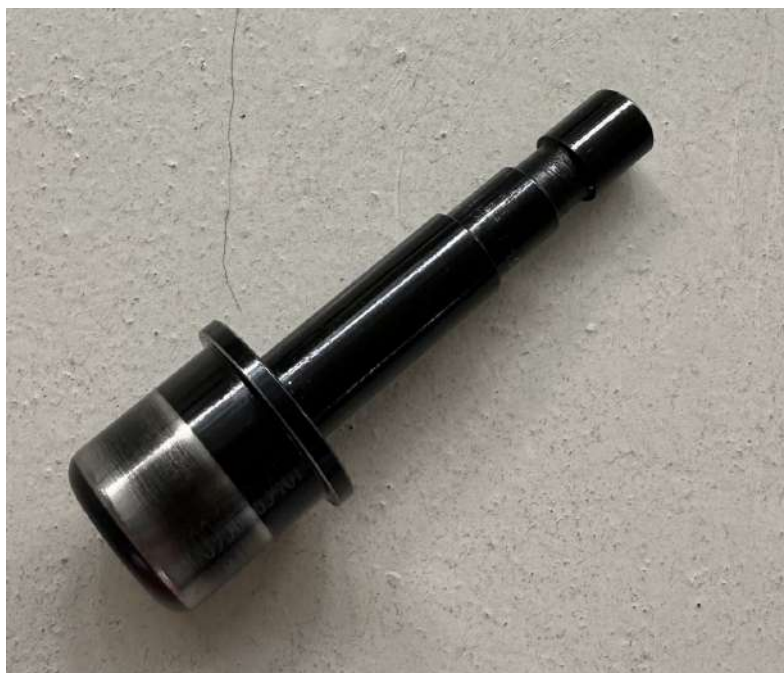
Slika 12: Nastavek za preverjanje vrtilnega momenta.
