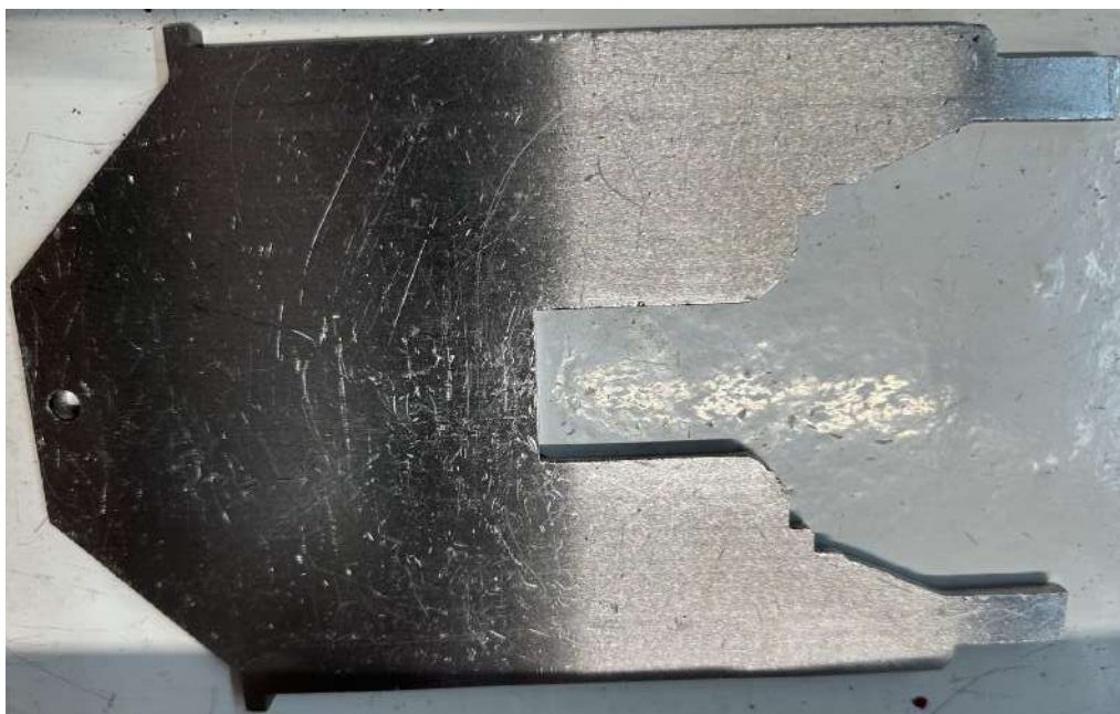
Slika 7: Silhueta za preverjanje zunanje oblike HKZ.
