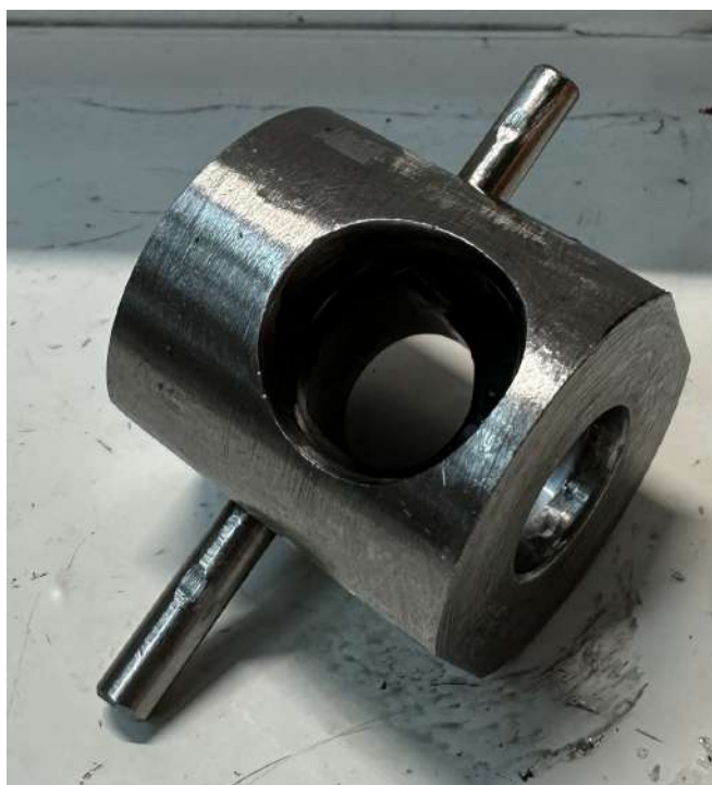
Slika 8: PokaYoke za preverjanje ustrezne velikosti kroglic.
