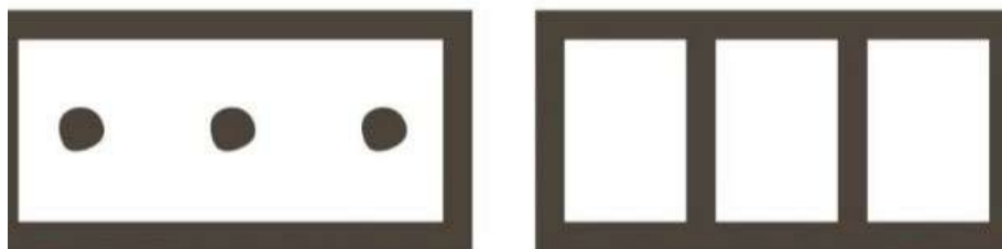
Slika 13 Pravilen nanos lepila na izolacijsko ploščo
