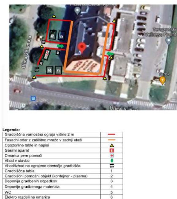
Slika 5 Načrt ureditve gradbišča
