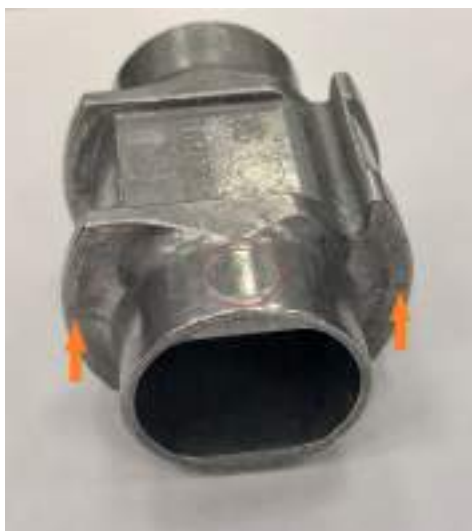
Slika 20: Prikaz delov delilne površine in odtisa izmetača s srhom
