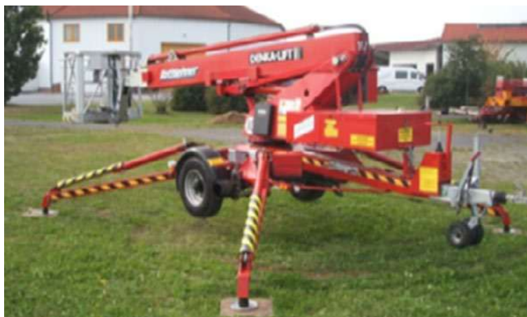
Slika 2: Delovna ploščad priklopnika tipa 1B
