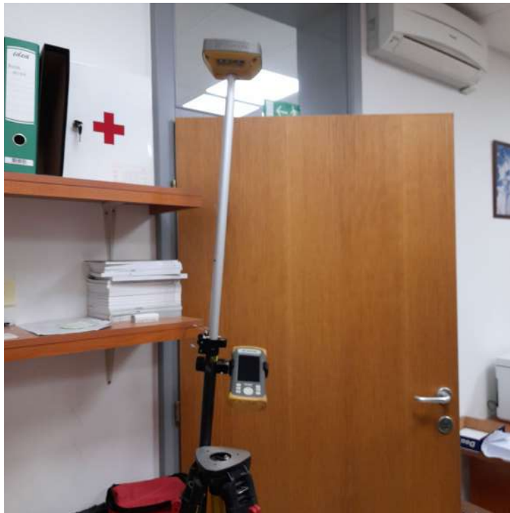
Slika 6: Merski komplet GNSS za terenske meritve
